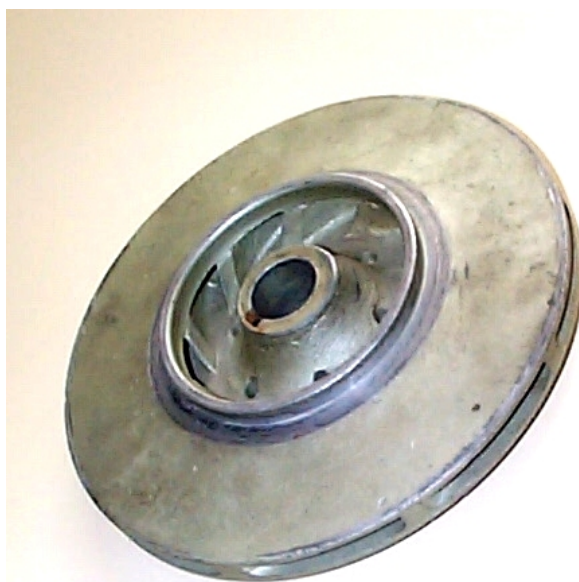
4. ábra Radiális átömlésű járókerék
